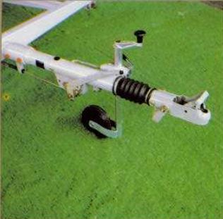
Equipment standard avec frein à inertie, frein à main roue timon.
