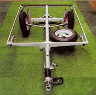
Le chassis supports une charge de 500 kg. Das Fahrgestell, reicht für 500 kg Tragfähigkeit.
