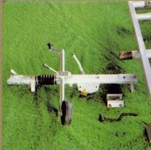
Timon facilement démontable, permettant un entreposage facile.
