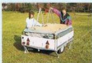
Aufstellen der Liegeplattenstützen
